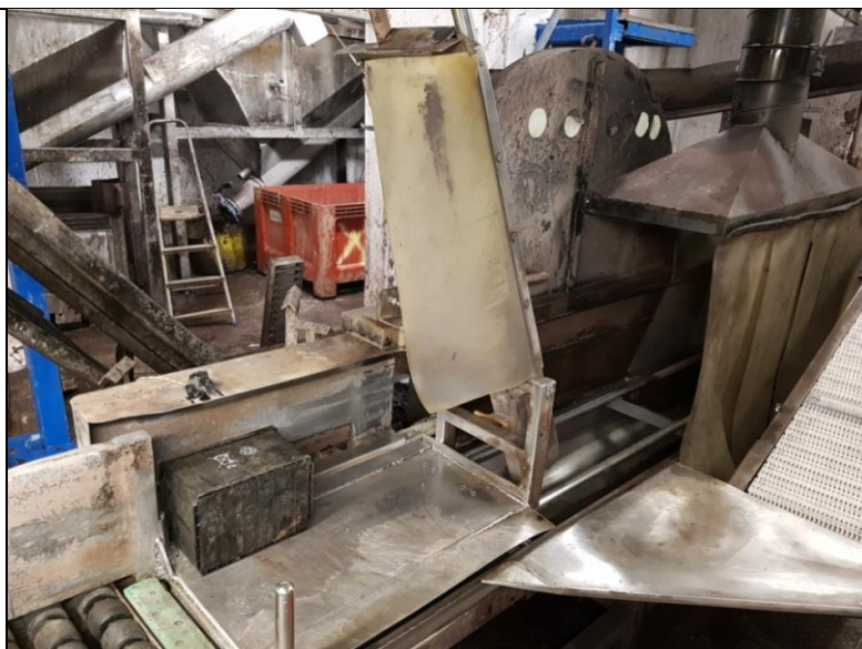
Slika 8. Pila za odsijecanje gornjeg dijela akumulatora
