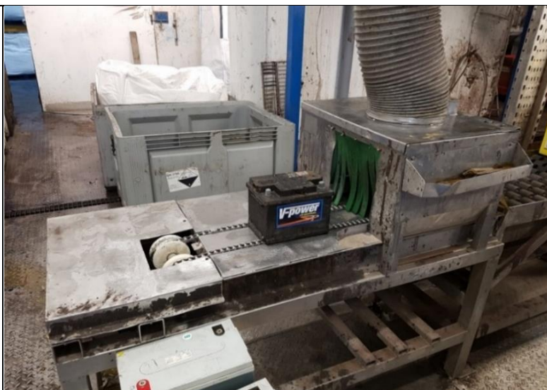
Slika 4. Stroj za prorezivanje akumulatora i izlivanje elektrolita
